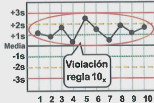
Al ingresar el dato de control en el software Unity Real Time, las reglas de alarma y rechazo de la corrida analítica establecidas por el laboratorio se aplican de manera automática y se visualizan en la pantalla de ingreso de datos.
